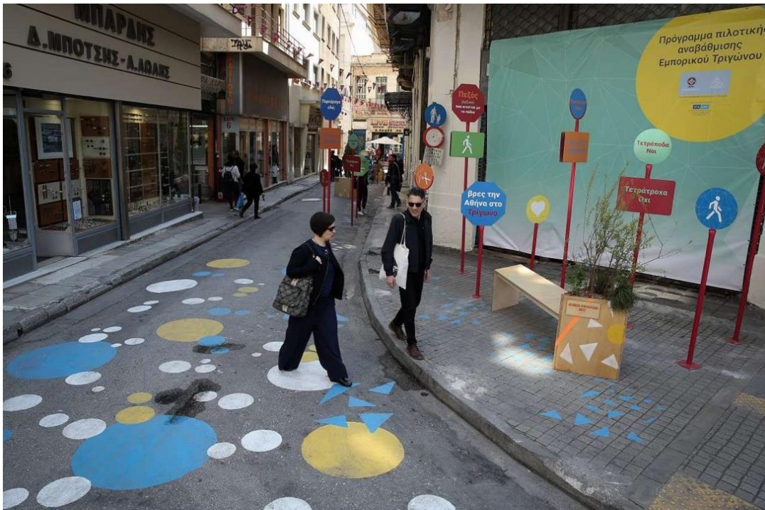
Εικόνα 29. Πεζοδρομημένες οδοί στο εμπορικό τρίγωνο της Αθήνας. Διακρίνονται οι χρωματισμοί στο έδαφος, η τοποθέτηση χώρων στάσης και η κατακόρυφη σήμανση που, σε πρώτο χρόνο, ενημερώνει τους χρήστες για την αλλαγή του χαρακτήρα των οδών.
